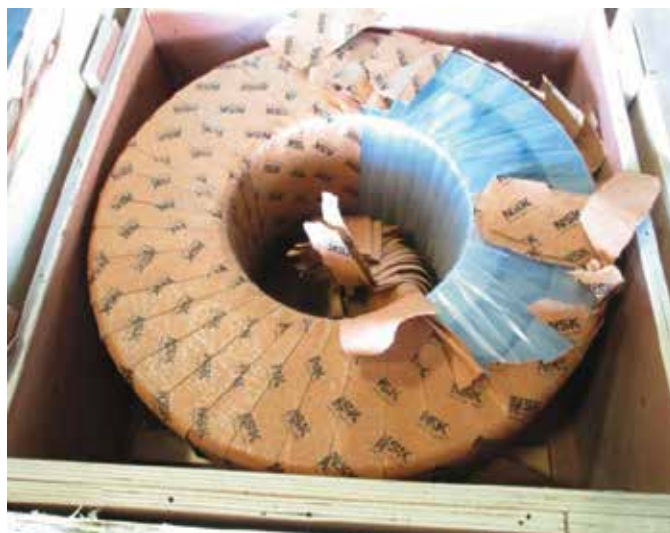
Beide Fotos zeigen Fälschungen. Falsche Verpackung und fehlende Kennzeichnung der Wälzlager.
